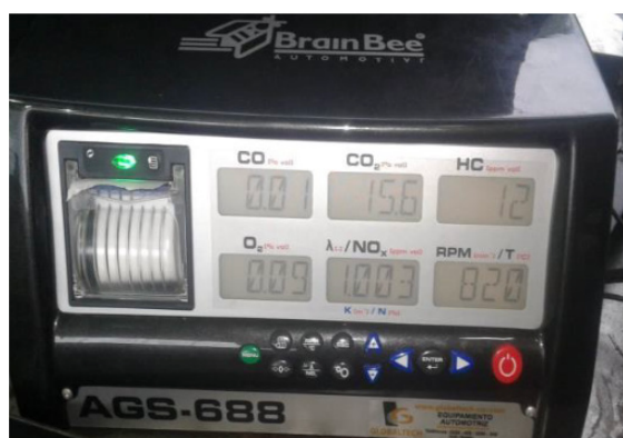
Figura 2 Analizador de Gases Brain Bee AGS-688
